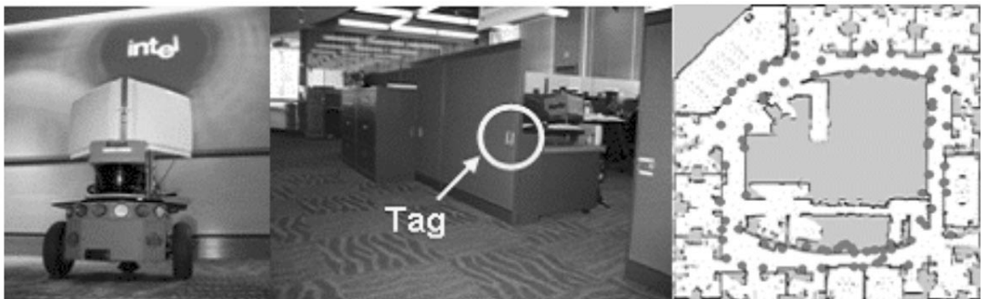
〈그림 4〉 왼쪽: RFID 판독기를 장착한 로봇의 모습, 가운데: 실내 배치된 RFID 태그의 예, 오른쪽: 2차원 환경지도의 예 (검은색 원은 RFID 태그의 위치)
