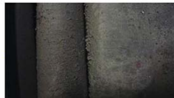
[그림 5] 보일러 해체後 연관부에 쌓인 스케일 상태
