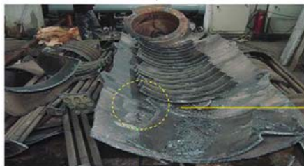
[그림 5] 보일러 해체後 연관부에 쌓인 스케일 상태
