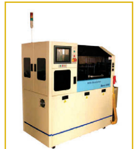
▶프로센의 초정밀 자동화장비 Auto lens gate cutting system. (위쪽이 walking beam type, 아래쪽이 elevator type)
