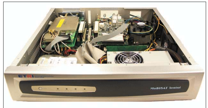
〈그림 3〉 이동체 내부에 설치되는 위성단말 장치로 승객에게 제공되는 서비스 종류에 따라 인터넷, 휴대폰, TV 접속 기능 등 다양하게 구성된다.
