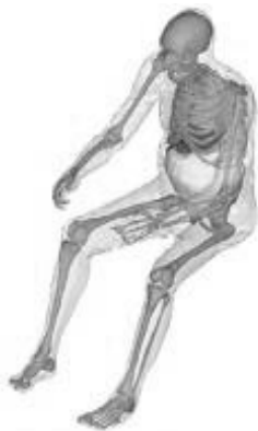
〈그림 7〉 MADYMO의 50th percentile male 유한요소모델
