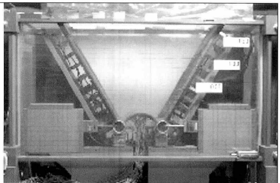
그림 5. Arrangement of load cells and an experimental model
