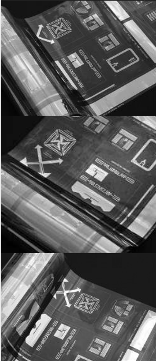
[사진 2] 롤투를 프린팅 방식 RFID 태그 안테나
