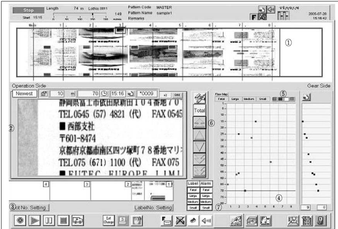
[그림 5] Futec Easy Max MC 인쇄 결점 검사기 조작화면 설명서
