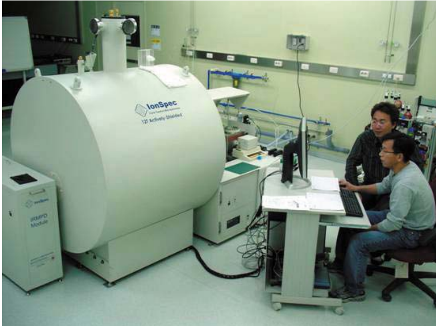
한국표준과학연구원에 설치된 12 Tesla 자장의 ESI FT-ICR MS
