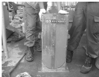
[사진 6] U형 충전시험 모습
