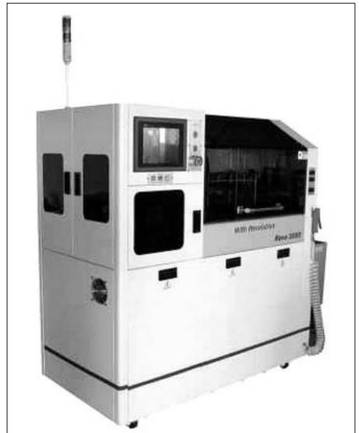
▶프로센의 주력제품인 자동 렌즈 게이트 커팅 시스템(Auto Lens Gate Cutting System. 첫 번째가 Walking Beam Type, 두 번째가 Elevator Type)
