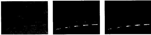
(그림 8) 블록매칭 알고리즘에 의한 결함 검출 : (a) 결함을 가진 영상, (b) 블록매칭 방법의 적용, (c) 후 처리 (Fig. 8) Image of defects detected by block matching method: (a) A defect image; (b) The result image of BM algorithm; (c) The result image of post-processing
