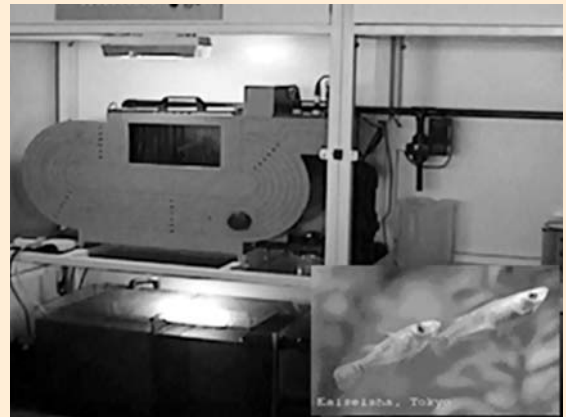
〈그림 2〉 물고기를 이용한 수질 독성 모니터링 장치, 물고기가 물의 흐름에 역방향으로 유영하는 것에 착안하여 구성된 장치로 독성에 의해 물고기 유영 속도가 줄어들게 되면 챔버 뒷부분의 센서를 작동시키는 원리로 수질 독성을 판단한다.
