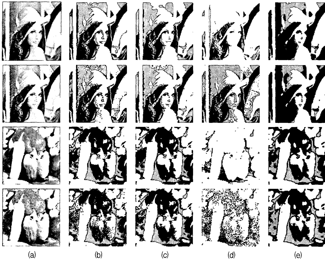
그림 3. Lenna영상과 Peppers영상에 각 알고리즘을 적용한 결과영상. (a) : 원영상, (b) : FCM 알고리즘의 결과, (c) : Yang 알고리즘의 결과, (d) : Ahn 알고리즘의 결과, (e) : 제안한 알고리즘의 결과
