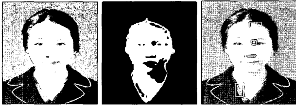
(a) 입력 영상 (b) 이진화 영상 (c) 영역 추출 (그림 15) 조명의 미 설정(촉광)으로 인한 결과 획득 실패 영상
