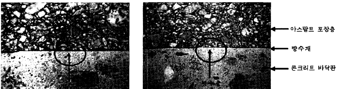
그림 7. 방수시스템 시편의 절단면(밀입도)
