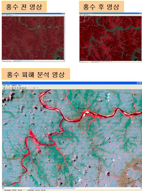
그림 6. LANDSAT 위성영상을 이용한 변화탐지
