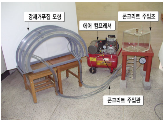
그림 2. 라이닝 콘크리트 타설모형실험 개요도
