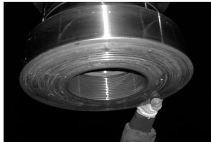
[그림 3] Guide Pad 및 Thrust Collar의 손상 표면
