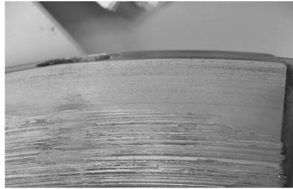
[그림 2] Thrust Bearing Pad의 손상 표면
