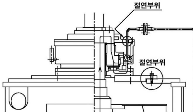
[그림 5] 절연된 모터상부 Endshield 및 Bearing Cover의 냉각수관 관통부위
