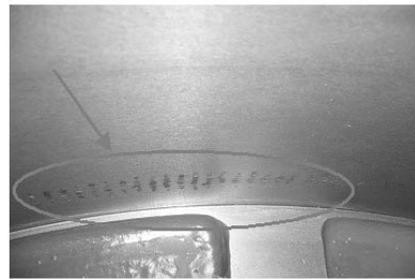
[그림 4] 베어링 냉각기 및 베어링 케이싱 내부 접촉으로 인한 전식
