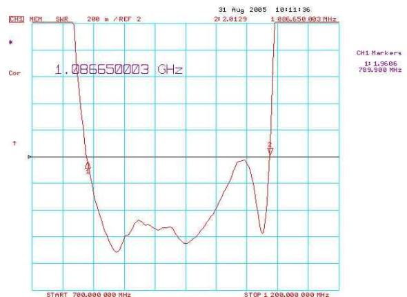
그림 8. 제작된 안테나의 VSWR Fig. 8. Measured VSWR plot of the manufactured antenna.
