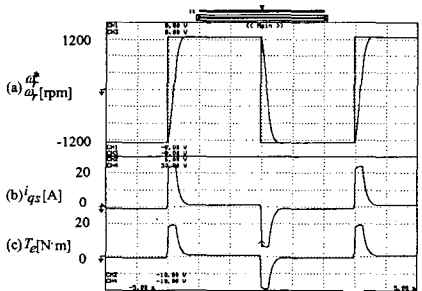
그림 12 스텝 지령속도의 변화에 대한 HAI 제어기의 응답특성
