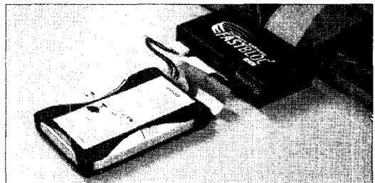
그림 2. 쓰기방지장치가 부착된 디스크 Fig. 2 Hard Disk Equipped with Anti-writing Device
