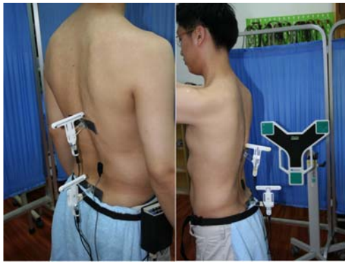
그림 2. 동작분석 시스템 능동 표식자의 부착 위치
