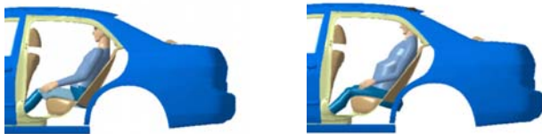
그림 4. 후석 거주성 평가 [한국인 HUMAN 95 th Percentile(좌) VS. 한국인 표준 운전자 95 th Percentile(우)]
