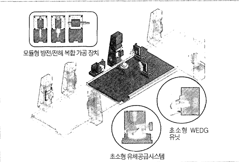
그림 6 2차원 평면 모터를 이용한 미세 방전/전해 가공용 마이크로 팩토리(연세대 학교)
