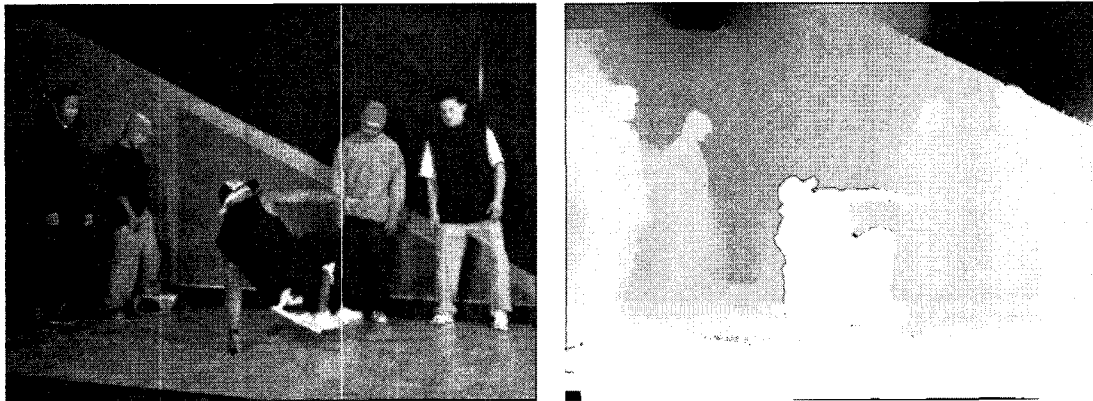
그림 7. 8대의 입력 카메라로부터 주어진 정보를 사용하여 렌더링 한 중간영상과 깊이영상 Fig. 7. Novel view and depth map synthesis using 8-view input data
