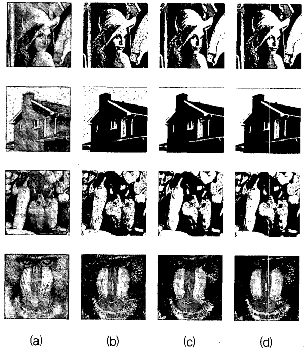
그림 3. 잡음 제거 성능 비교 (a) 5% salt&pepper 잡음이 추가된 영상 (b) FCM 알고리즘에 의한 코드 영상 (c) Yang 방법에 의한 코드영상 (d) EWFCM 알고리즘에 의한 코드영상
