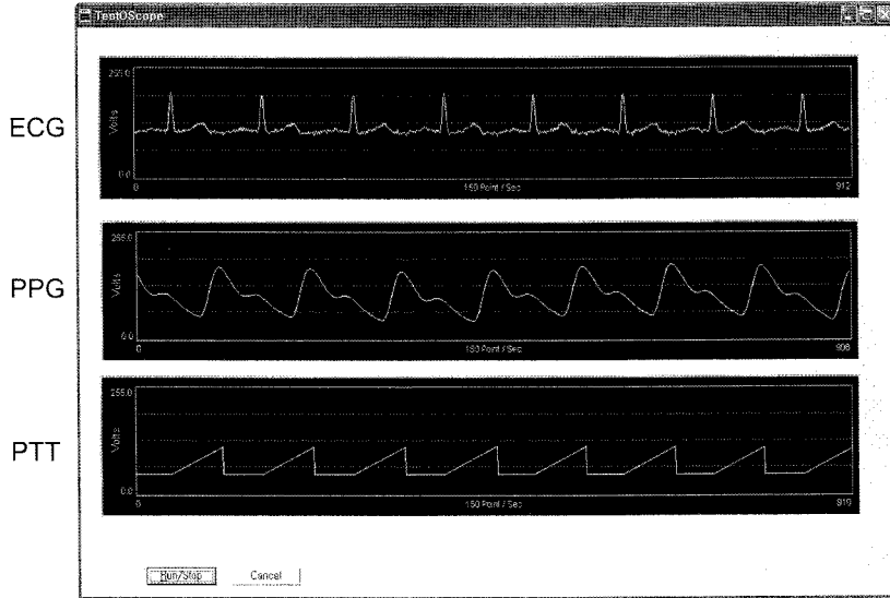
그림 5. Visual C++ 프로그램을 사용하여 생체신호의 실시간 디스플레이 Fig. 5. Display of real time biosignals.
