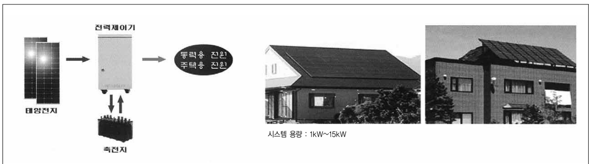
태양전지로부터 발전된 전력을 축전지에 저장하여 사용하는 시스템
