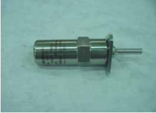
그림 4. Configuration of KOMPSAT-2 Fill/Drain Valve
