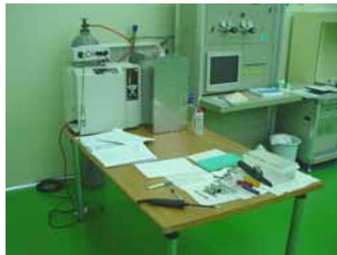
그림 12. Leakage Test Equipment
