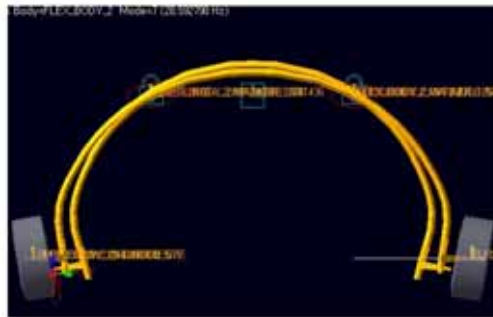
그림 8. 지상 반력 전/후의 착륙장치 형상
