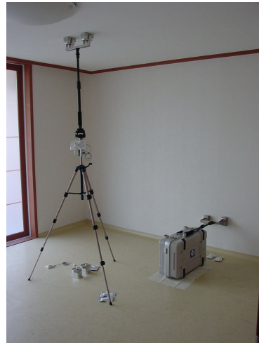
그림 2. 패시브 플릭스 측정장치의 일종인 ADSEC
