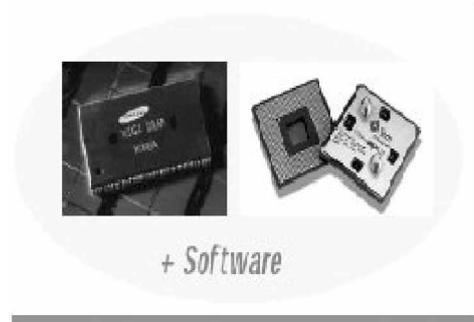
그림 3. 메모리반도체와 비메모리반도체의 통합칩 SoC
