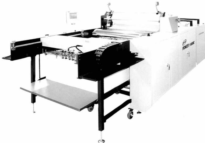
(주)지엠피가 최근 인쇄 산업용 써멀 라미네이터 Pioneer를 출시했다. Pioneer-7000BC는 최대 7000(W) X 1100(L)mm 규격의 용지를 분당 최대 30M 까지 라미네이팅 작업이 가능하며 Pioneer-11000BC는 최대 11000(W) X 1200(L)mm 규격의 용지를 분당 최대 60M까지 처리가 가능한 신속성을 자랑한다. 원쪽은 Pioneer-11000BC 아래는 Pioneer7000BC
