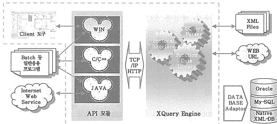
엑스페이스(X-space)는 다양한 입력도구(Tool, 프로그램 등)로부터 요청된 XQuery 문장을 API를 통해 XQuery 엔진에 전달하고 XQuery 엔진은 XQuery 구문을 해석하여 데이터 저장장치(XML File, RDBMS 등)로부터 요구하는 데이터를 추출하여 API를 통해 요청한 입력 도구에 결과 데이터를 전달하게 된다. 이는 간단한 XQuery 문장과 API만으로 처리하기 때문에 획기적인 생산성의 향상을 기대할 수 있다
