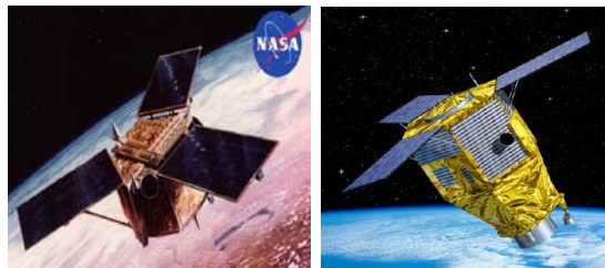
그림 6. Ikonos(1999)와 Pleiades(2008) 3 Axis Control Zero Momentum Bias Satellite
