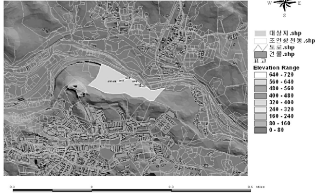
그림 1. 수치지형도의 등고선에 GRID TIN을 이용한 표고분석
