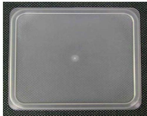
그림 5. 시험사출에서 생성된 밀폐용기 덮개 성형품의 예제.
