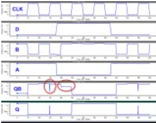
그림 4. Yuan의 D-플립플롭에 대한 클럭 경사 민감도 모의실험 결과 Fig. 4. Simulation results of Yuan's D-flip flop for clock-slope sensitivity
