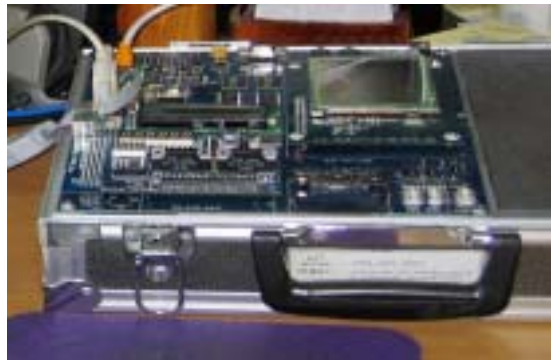
그림 5. 구현된 미터링 하드웨어 Fig. 5. Implemented metering hardware
