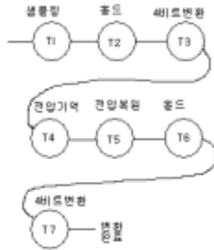
그림 6. ADC 상태도 Fig. 6. State Diagram of the Proposed ADC
