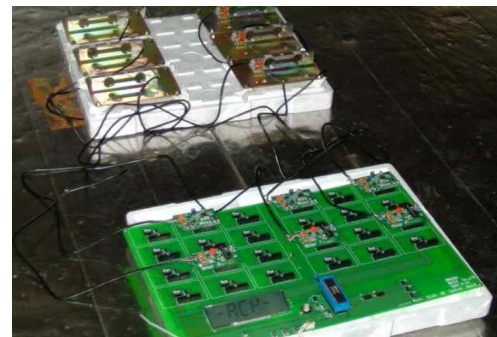
그림 4 항온조에서 로드셀센서와 구성하여 시험중인 사진
