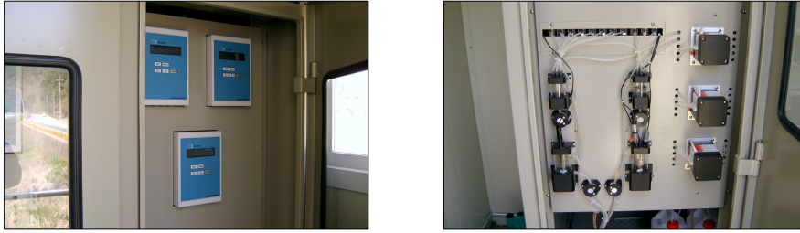
그림 3. 매일수위국의 실시간 수질관측을 위한 분석장비
