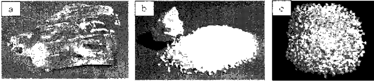
[그림 5] MgO 재료의 여러 가지 형태 (a) 파쇄 전의 단결정 형태 (b) 파쇄 후의 단결정 (c) 다결정 재료
