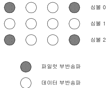
그림 6. 상향링크 PUSC 타일의 구조 Fig. 6. Description of an uplink tile.
