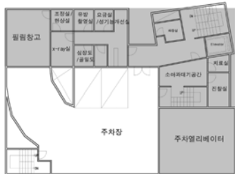
그림 21. U자형-지하1층 주차장 및 진료공간
