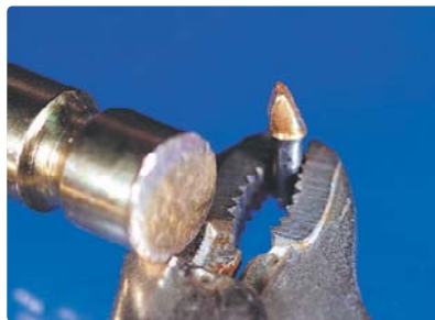
그림 19. 플라이어로 lab analog를 완전하게 짝 잡은 다음 약하게 망치로 치면 충격요법에 의해 GES 코핑이 순간적으로 빠져 나온다.
