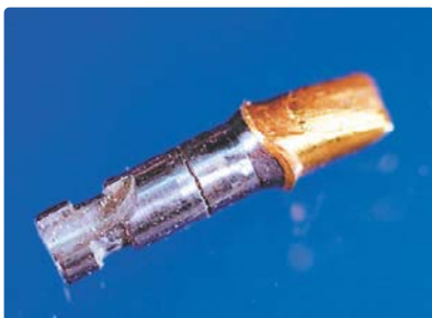
|| 그림 17. Lab analog에서 동선을 제거
