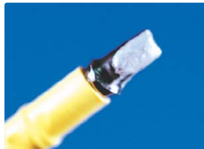
그림 10. 수축성 튜브를 끼우고 열을 가해 동선과 analog를 완전하게 고정
