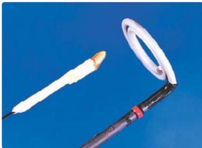
|| 그림 15. 6시간의 전기 전착이 완료된 후 plating head에 부착된 동선과 치형
