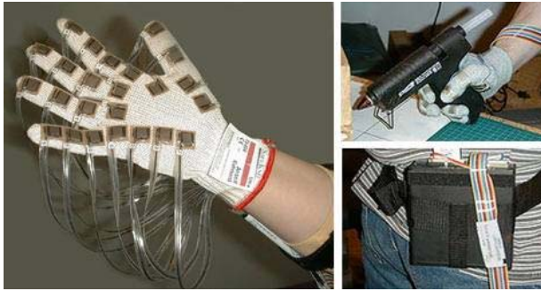
그림 1. FSA hand force measurement system
