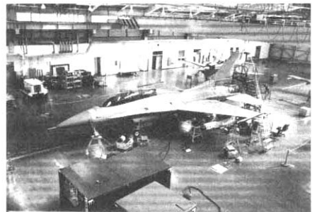
그림 1. KF-16D 항공기 지상진동시험
