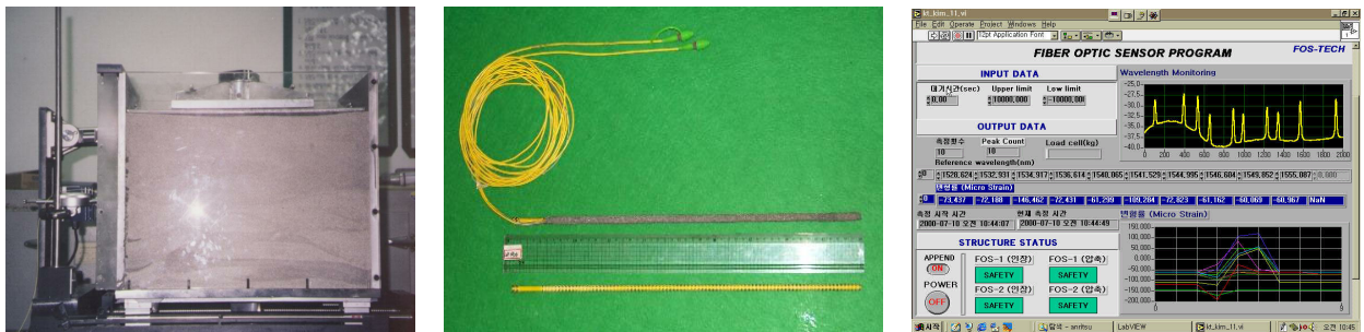
그림 4 토조 박스(좌측), FBG 센서가 심겨진 네일(중앙), Software(우측).
